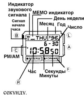
На рис.1., изображен общий вид часов в режиме Текущего времени. Кнопка С осуществляет переход между режимами часов. После осуществления необходимых действий в любом режиме, нажмите кнопку С для возврата в режим текущего времени. Переход между режимами осуществляется в следующей последовательности:
