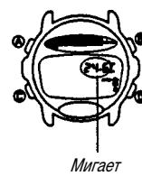
1. Нажмите кнопку «A» и удержите ее в нажатом состоянии в режиме термометра до тех пор, пока на табло ваших часов не начнут мигать цифры, соответствующие значению текущей температуры.
