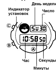
На рис.1., изображен общий вид часов в режиме Текущего времени для модуля 1536/1636.
