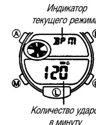
Режим отсчета ударов ритма можно использовать для подачи звуковых сигналов, частота которых соответствует заданному количеству ударов в минуту. Эта функция аналогична цифровому метроному, широко применяемому в музыке.
