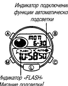
На этих часах используется электролюминесцентная подсветка, позволяющая легко считывать показания на табло в темноте. Автоматическая подсветка циферблата срабатывает всякий раз, когда вы поворачиваете к себе руку с часами, чтобы посмотреть на них. Функция подсветки может быть подключена таким образом, что подсветка будет мигать всякий раз при подаче звукового сигнала будильника или сигнала начала часа.
