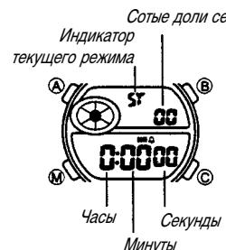
Режим секундомера позволяет измерять отдельные отрезки времени, разделенное время, а также фиксировать время первого и второго места. Общий измеряемый интервал времени составляет 23 часа 59 минут 59,99 секунд.
