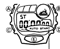
Индикатор автоматического запуска
