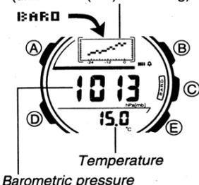
1. Измерения атмосферного давления и температуры начинаются автоматически при входе в Режим Барометра/Термометра. На дисплее появляется индикация "BARO".
