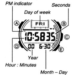
3. Если вы выбрали для коррекции секунды (изображение секунд мигает), нажмите кнопку “E” для сброса значения счетчика секунд в 00. Если вы нажмете кнопку “E” при значении счетчика секунд между 30 и 59, то значение счетчика установится в 00 и 1 прибавится к счетчику минут, если значение счетчика секунд будет между 00 и 29, то изменение счетчика минут не произойдет.
