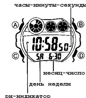
На рисунке изображен общий вид часов в Режиме Текущего Времени. Нажмите кнопку “С” для перехода из режима в режим в следующей последовательности:
