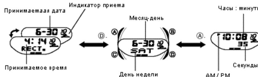
На рисунке изображен общий вид часов в режиме текущего времени. Нажмите кнопку "С" для перехода из режима в режим.
