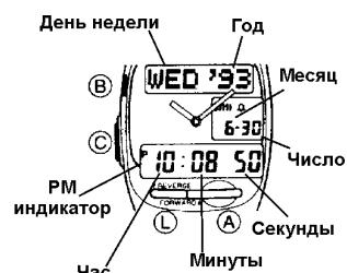
На рисунке изображен общий вид часов в режиме Текущего времени. Общий вид корпуса часов может различаться для разных модификаций.
