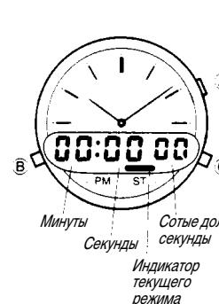
Режим секундомера позволяет вам фиксировать отдельный отрезок времени и суммарное прошедшее время. Диапазон измерений секундомера ограничивается значением времени, равным 59 минутам 59,99 секундам.
