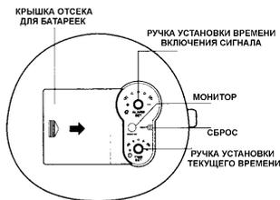
1. Открыть крышку отсека для батареек, нажав и сдвинув крышку в направлении, указанном стрелкой на крышке.
