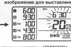
2. Выбрать выставляемый параметр и изменить его с помощью кнопок «HR/MONTH» button (②), «MIN/DATE» (③) и «YEAR/5-AL ON/OFF» (④).
