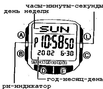
На рисунке изображен общий вид часов в Режиме Текущего Времени. Нажмите кнопку "B" для перехода из режима в режим.
