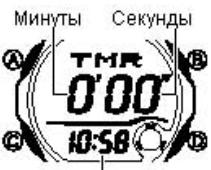
Обратный отсчет времени может быть задан в диапазоне от 1 минуты до 60 минут. Как только счетчик обратного отсчета достигнет нуля, подается звуковой сигнал.
