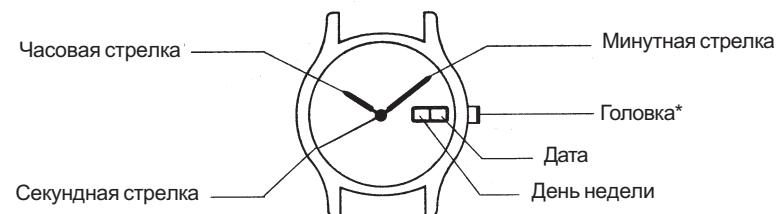
\* Некоторые модели часов имеют головку с винтовым фиксатором вместо стандартной головки.
