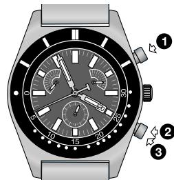
Функция SPLIT-TIME (разделить) позволяет останавливать стрелки для считывания промежуточного времени, в то время как отсчет времени продолжается. При повторном запуске стрелки "наверстывают" истекшее время.
