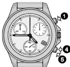
Функция SPLIT-TIME (разделить) позволяет останавливать стрелки для считывания промежуточного времени, в то время как отсчет времени продолжается. При повторном запуске стрелки "наверстывают" истекшее время.
